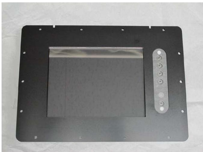
8.4 インチ TFT 液晶ディスプレイの高耐用性試作モデルです。本設計を基に、各種環境耐用設計を追加する事によってお客様のご要望に応じた耐用性を持つディスプレイモジュールを短期間にて試作製造することができます。
