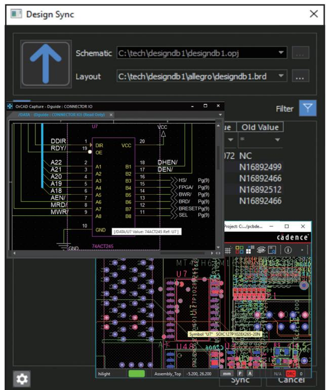
バックアノテーション機能で、基板レイアウト設計時に加えた変更が回路図にも反映されます。
